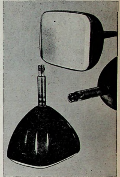
Figuur 2. De nieuwe televisiebuis van 30 cm totale lengte, en beeldvlak 19,5 x 22,5 cm.
